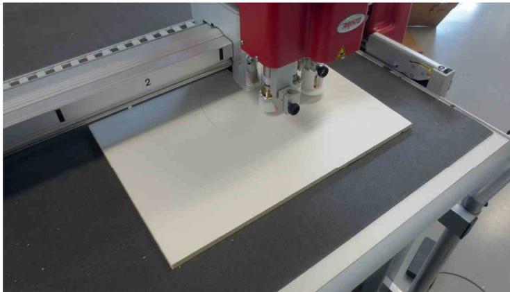
À partir du logiciel Flexletter, les élèves pilotent la machine. Le support utilisé pour les lettres en volume est du carton mousse.
